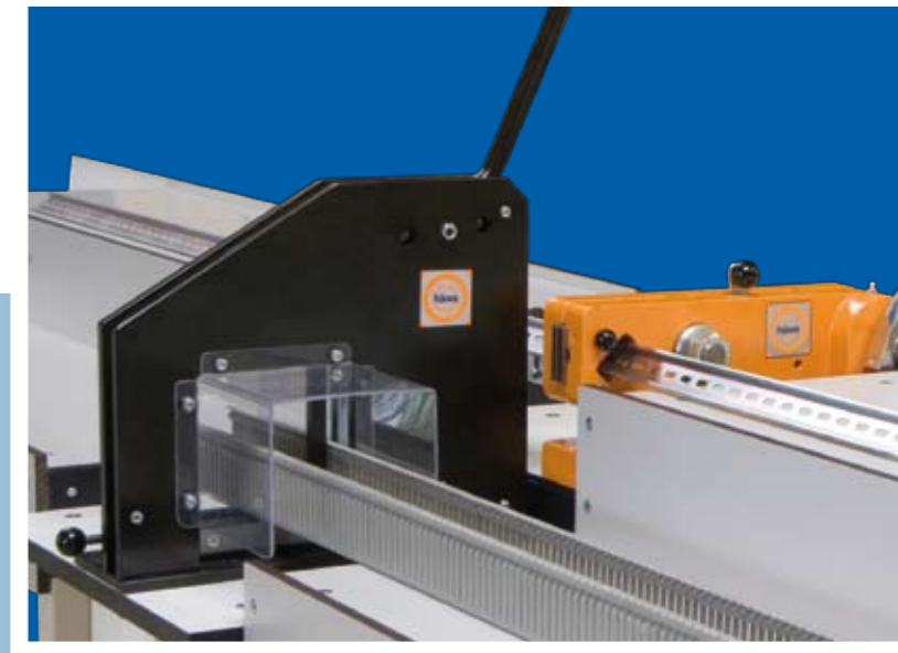
Zwei Arbeitsebenen mit motorischen Anschlägen
